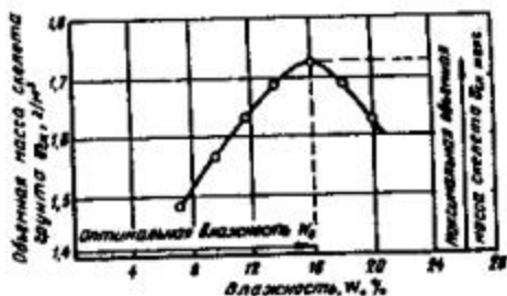
Рис. 46. Зависимость объемной массы скелета грунта от влажности при стандартном уплотнении
