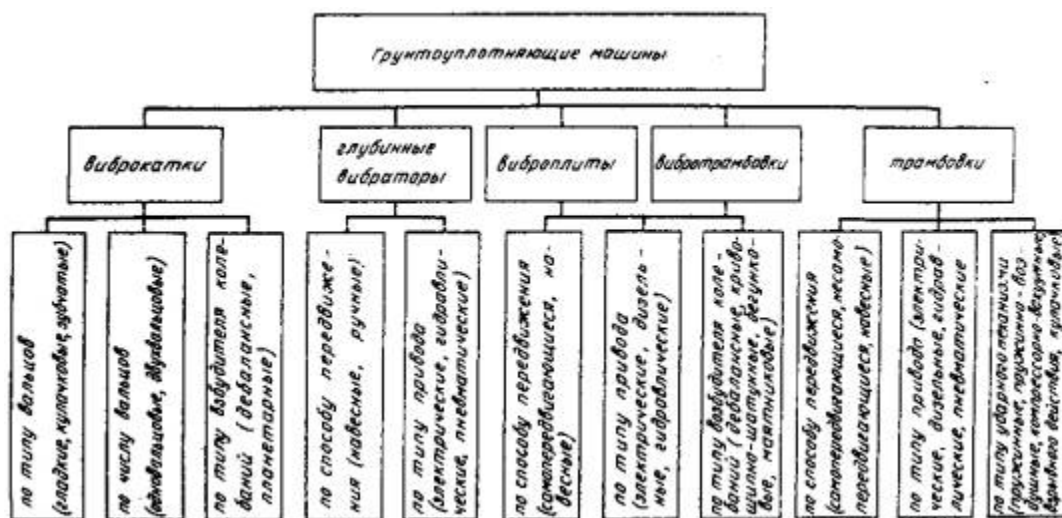
Рис. 12. Классификация машин для уплотнения грунта в стесненных условиях строительства
