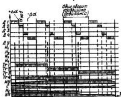
Рис. 67. Функциональная схема системы автоматического регулирования режимов работы виброударных машин
