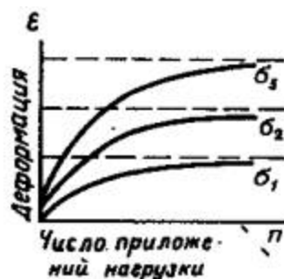
Рис. 9. Изменение деформации грунта в зависимости от числа приложений нагрузки
